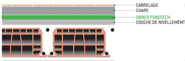
Le système de chape flottante signifie que la chape de finition est posée sur la sous-couche acoustique et est complètement séparée du support et des cloisons verticales. Le système sera alors libre de vibrer.
